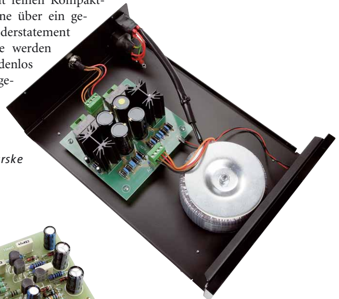
Oben: Das Zusatznetzteil verfügt über eine vielfache Stromlieferfähigkeit der Originalversorgung
